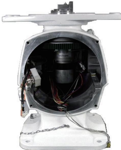
Vista posteriore con coperchio e modulo ricevitore RTR-101 rimosso.
