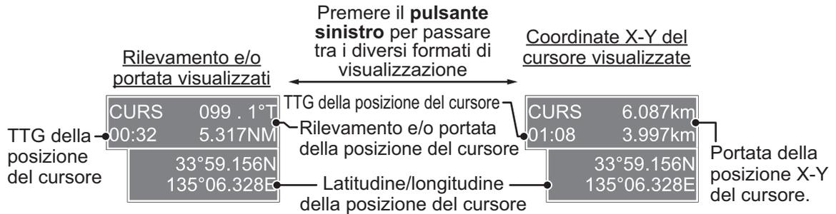
**Nota 1:** Per la visualizzazione delle coordinate X-Y, l'asse Y è la linea di prua, la metà inferiore dello schermo è "più" e la parte inferiore dello schermo è "meno". L'asse X è la direzione destra/sinistra, sinistra è "più", destra è "meno".
