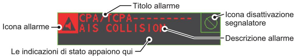
Disattivare il buzzer con il tasto **ALERT ACK** o selezionare la casella [ALERT], quindi premere il **left button**. Il segnale acustico e il lampeggiamento si interrompono ma l'indicazione di allarme rimane visualizzata sullo schermo fino a quando non viene rimosso il motivo dell'allarme.
